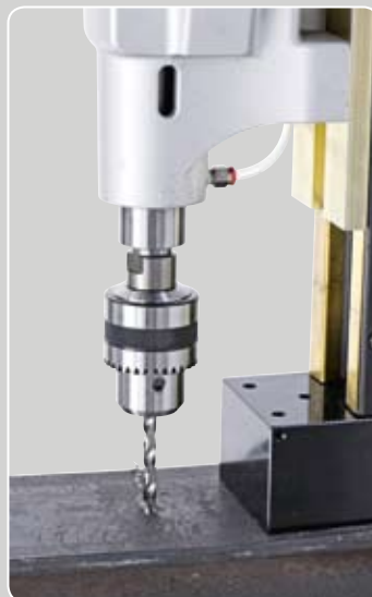
Spiralbohrer mit Bohrfutter
